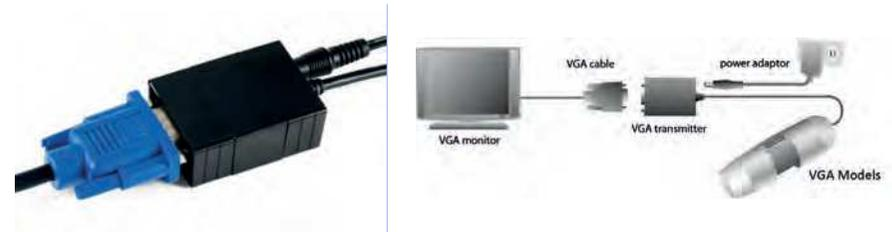
High Speed Real Time Modelle, die über einen VGA-Anschluss (D-SUB) direkt an einem Computermonitor/VGA-Bildschirm angeschlossen werden können. Diese Modelle bieten eine Bildwiederholung von bis zu 60 Bildern pro Sekunde, bei einer Auflösung von 800x600 Bildpunkten, und bietet zudem eine verbesserte Wiedergabe bei niedrigen Lichtverhältnissen. Weitere Information auf: [www.dino-lite.eu/highspeedrealtime](http://www.dino-lite.eu/highspeedrealtime).
